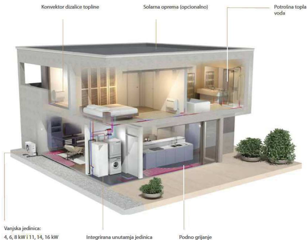
Slika 3.1 Primjer primjene dizalice topline u kućanstvu [8]
