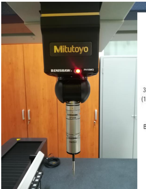
Slika 8.4 Renishaw PH10MQ mjerna sonda
