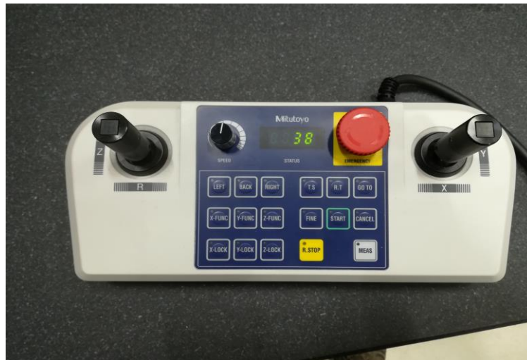
Slika 8.8 Komanda palica („Joystick box“)
