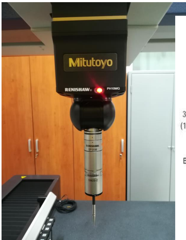
Slika 8.4 Renishaw PH10MQ mjerna sonda
