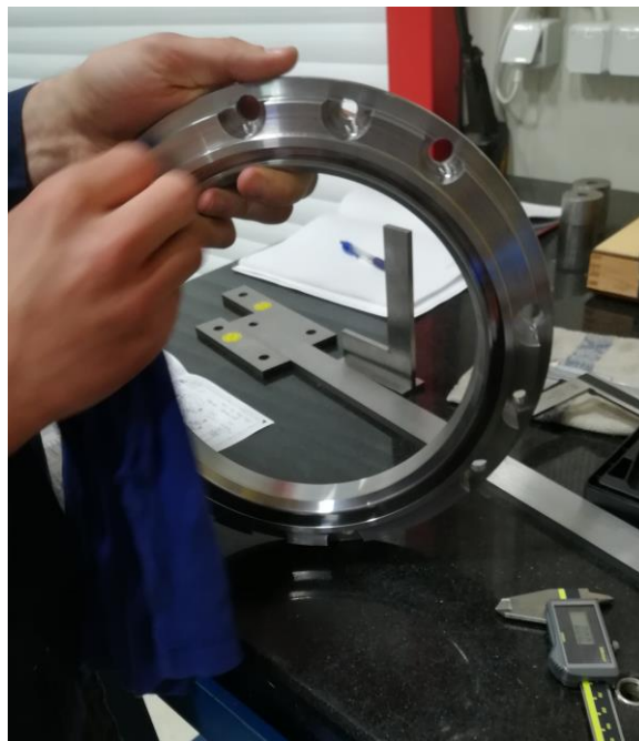
Slika 8.11 Čišćenje predmeta mjerenja prije mjerenja
