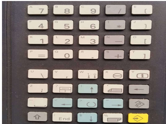
Slika 5.1. Adresno – numerička tipkovnica proizvođača Siemens
