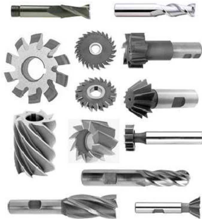
Slika 3.12. Glodala napravljena iz jednog komada [4]
