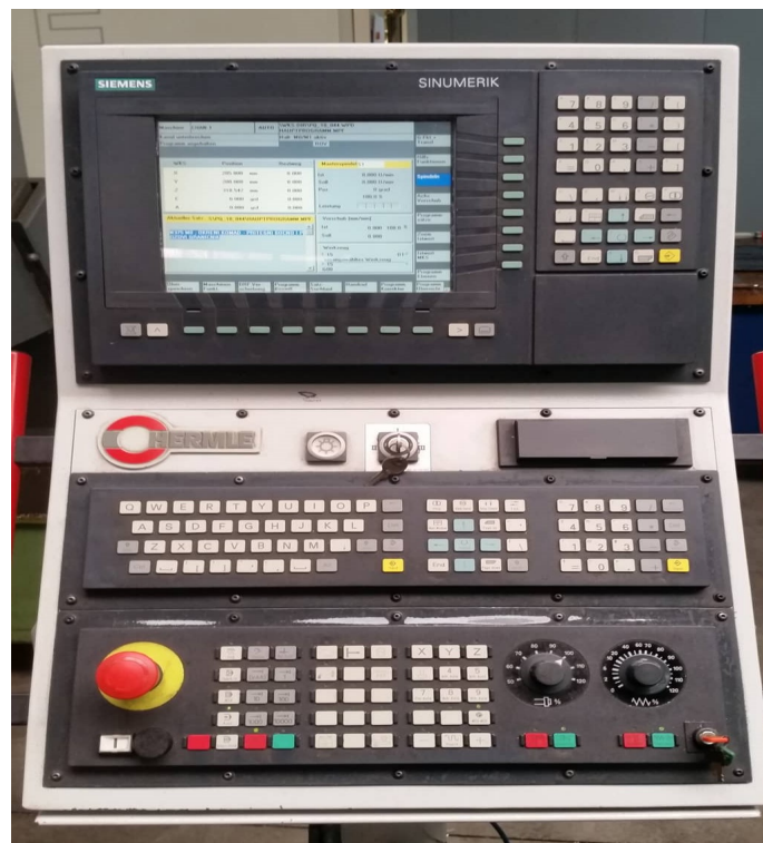
Slika 5.1. Upravljačka jedinica SINUMERIK
