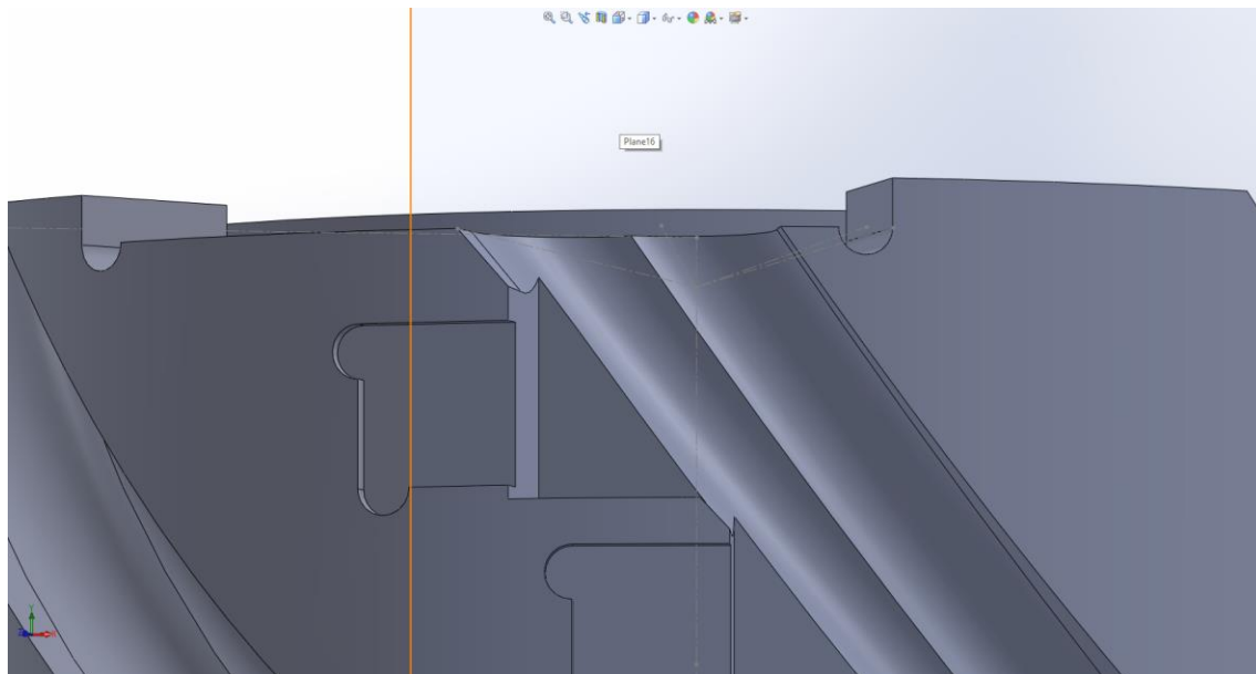
Slika 4-14. Izrada utora za pločice
