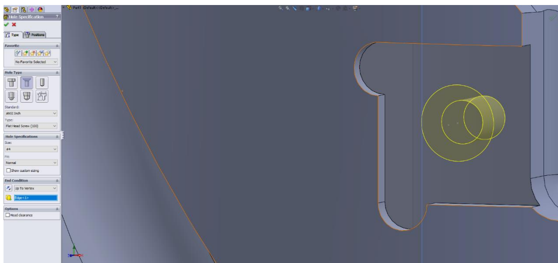
Slika 4-15. Izrada rupa sa navojem
