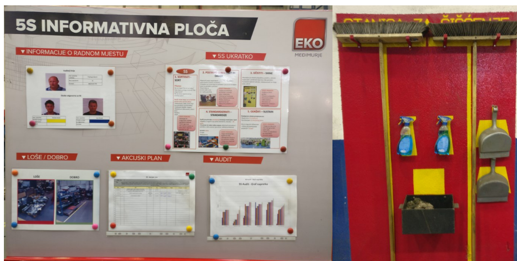
Slika 5.2.3. Stanica za čišćenje i 5S informativna ploča
