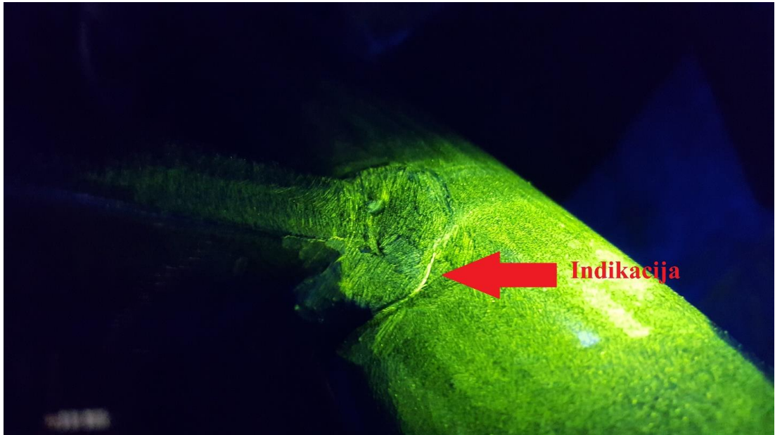
Slika 83: Indikacija otkrivena nakon što je na komad nanescena suspenzija i osvjetljena UV lampom
