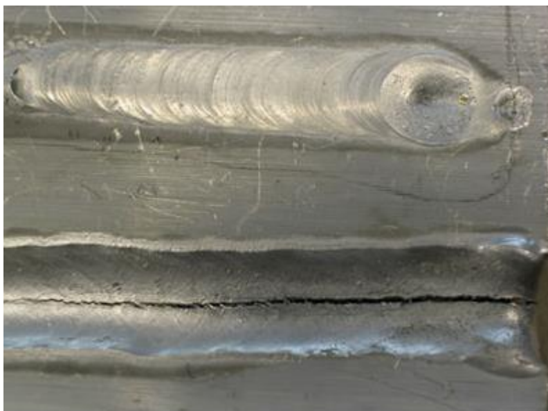
Slika 6: Uzdužno puknuće aluminjskog zavara [14]
