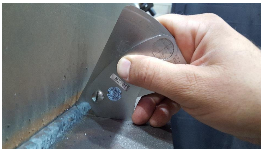
Slika 30. Mjerenje veličine zavara s donje strane
