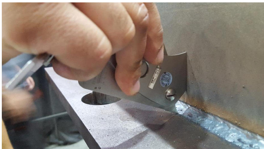
Slika 31: Mjerenje zavora s gornje strane
