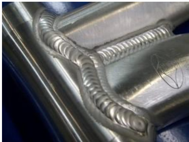
Slika 2.2 Zavareni spoj aluminija [7]
