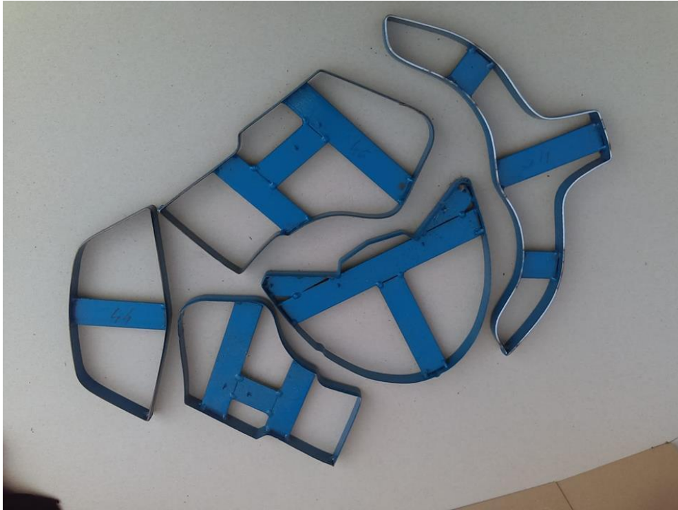
Slika 5 Noževi za štancanje
