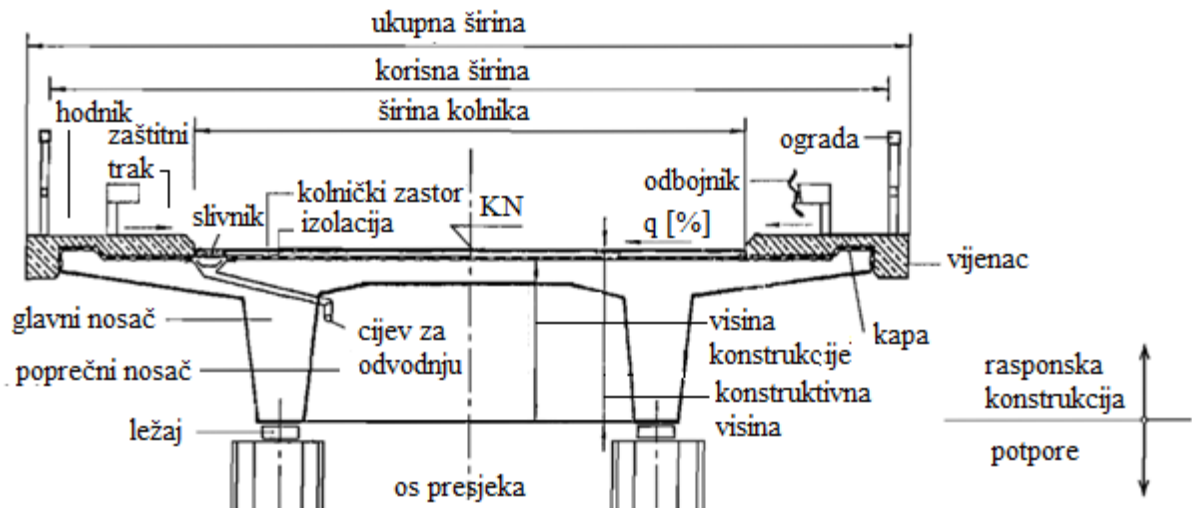
Slika 2.11. Gredni most rebraste konstrukcije – poprečni presjek
