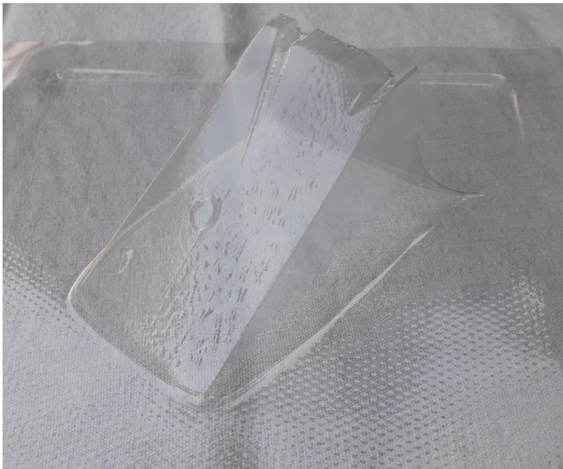
Slika 4.15 Drugi uzorak, t = 60 s, debljina folije = 0,5mm
