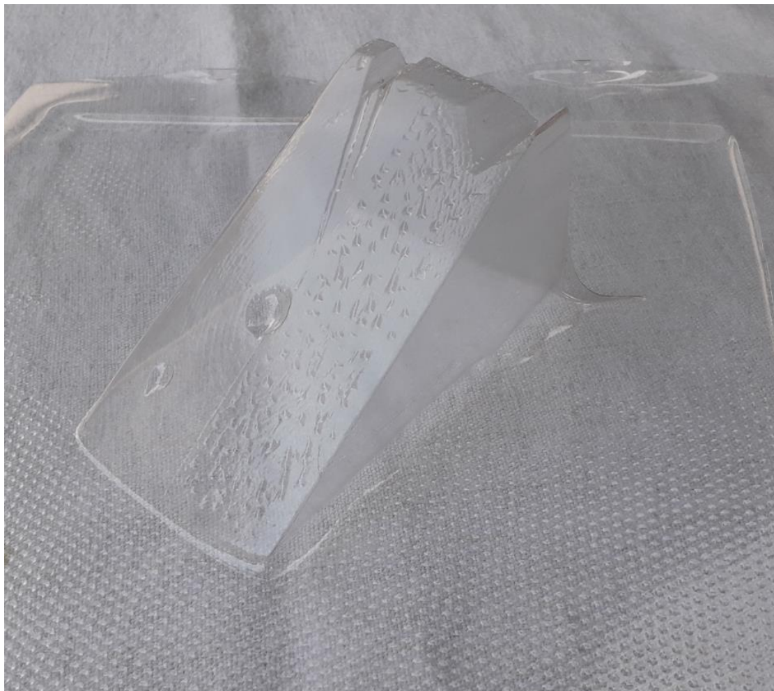
Slika 4.16 Treći uzorak, t = 90 s, debljina folije = 0,5mm
