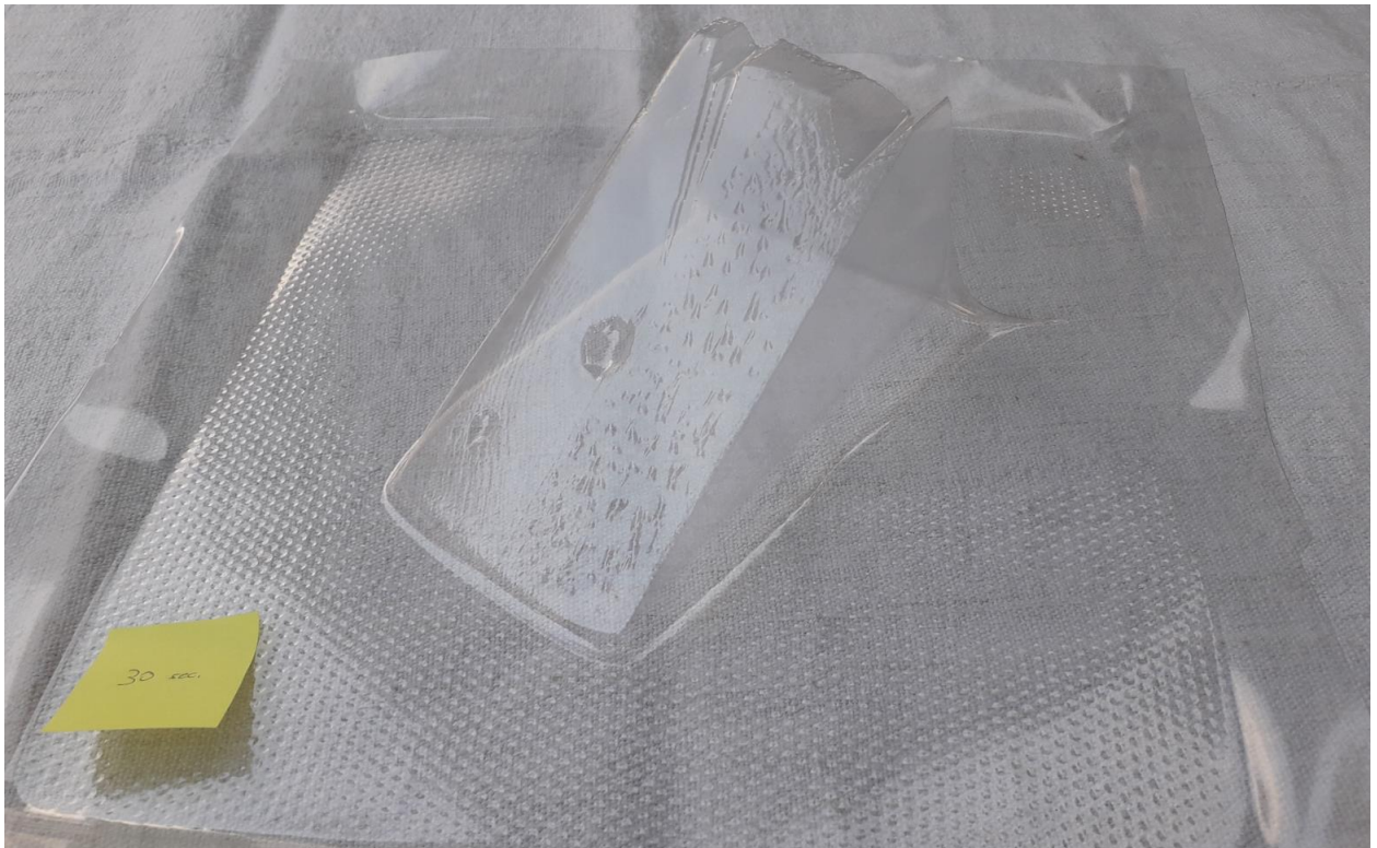
Slika 4.4 Drugi uzorak, t = 30 s, debljina folije = 0,3mm
