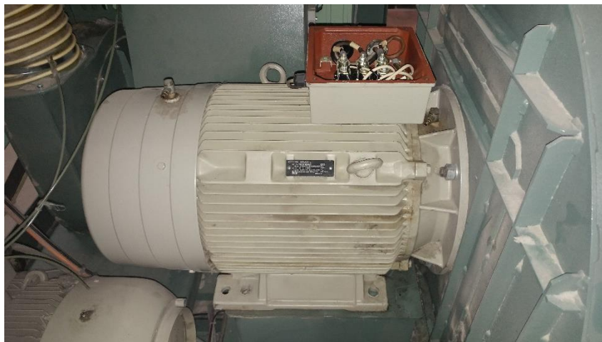
Slika 4.10. Prikaz asinkrona motora od 24,5 kW
