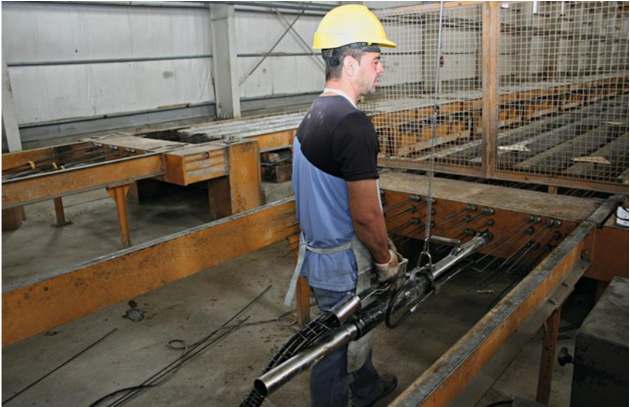
Slika 4.4 Hidraulička preša za zatezanje žica
