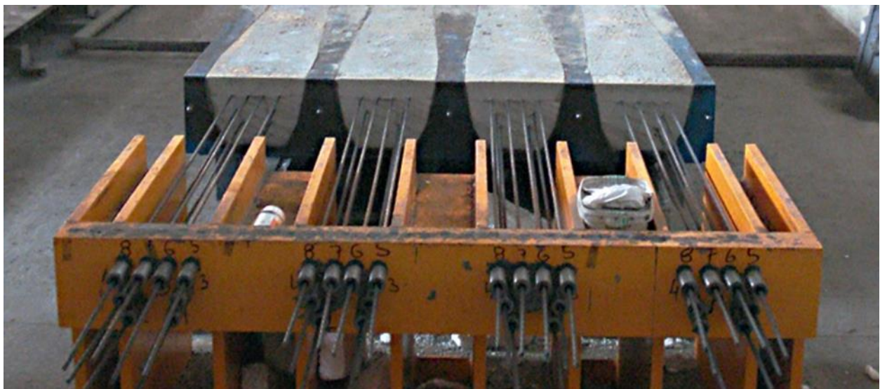
Slika 4.7 Očvrsnuli betonski elementi
