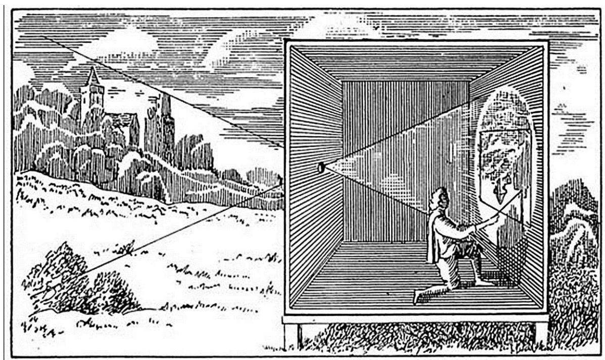
*Slika 1. Camera obscura, preteča svih vrsta aparata za fotografiska snimanja (analognih i digitalnih fotoaparata i kinematografskih, TV ili video kamera)*
