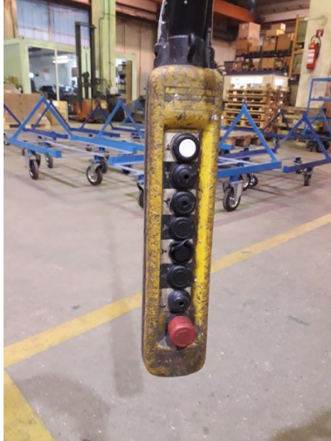
Slika 4.4: Viseći upravljački sklop [20]
