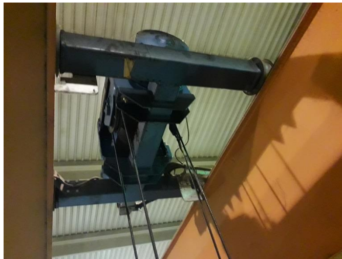
Slika 4.2: Transportni sklop dvotračne mosne dizalice [20]
