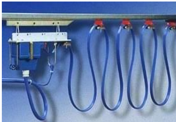
Slika 3.1: Kabelski vod koji napaja dizalicu [5]
