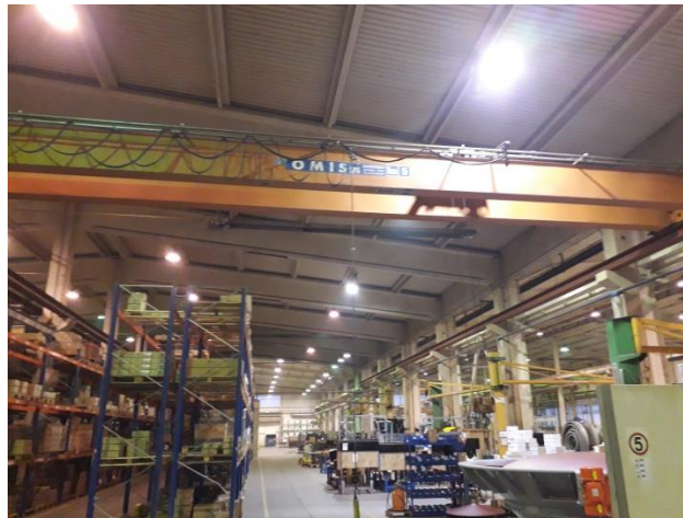
Slika 4.1: Mosna dvotračna dizalica [20]
