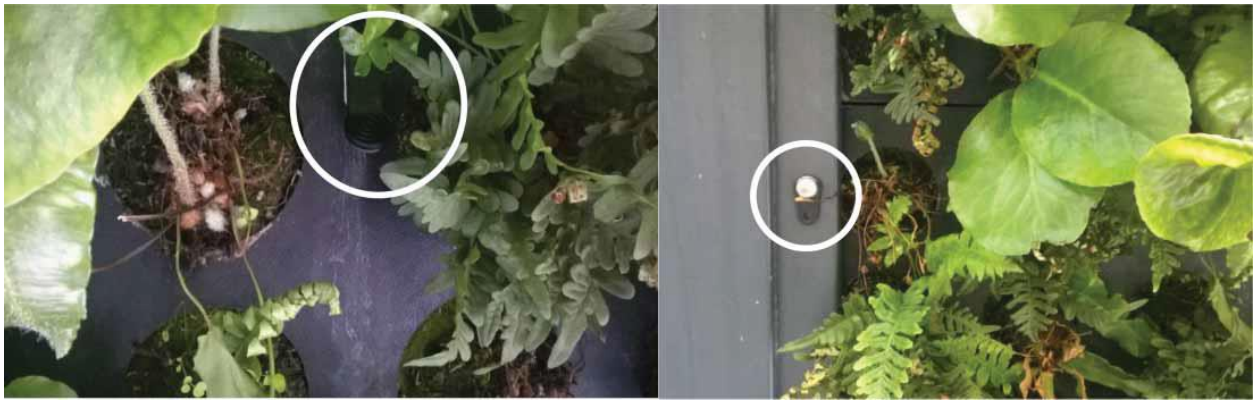
Slika 5.5.1. Sistem živućeg zida na mjestu 'C' sa prikazom smještanja iButton-a (izvor: MaricruzSoleraJimenez (2018) Green walls: a sustainable approach to climate change, a case study of London, Architectural Science Review, 61:1-2, 48-57, str.:51)
