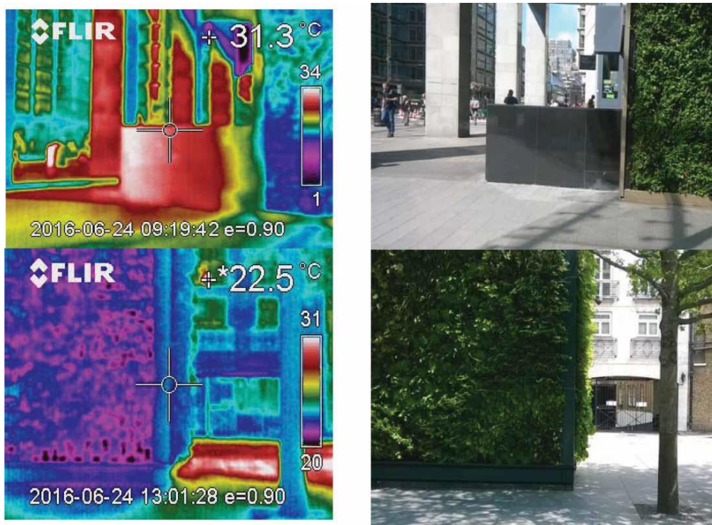
Slika 5.6.1. Fotografija snimljena infracrvenim fotoaparatom, usporedba površinskih temperatura (izvor: MaricruzSoleraJimenez (2018) Green walls: a sustainable approach to climate change, a case study of London, Architectural Science Review, 61:1-2, 48-57, str.:52)
