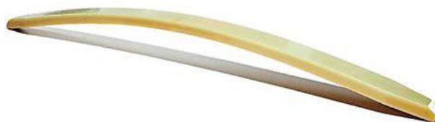
Slika 47. Lisnata opruga proizvedena RTM postupkom [3]
