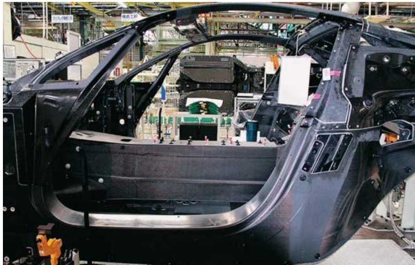
Slika 42. Karoserija Lexusa LFA [3]
