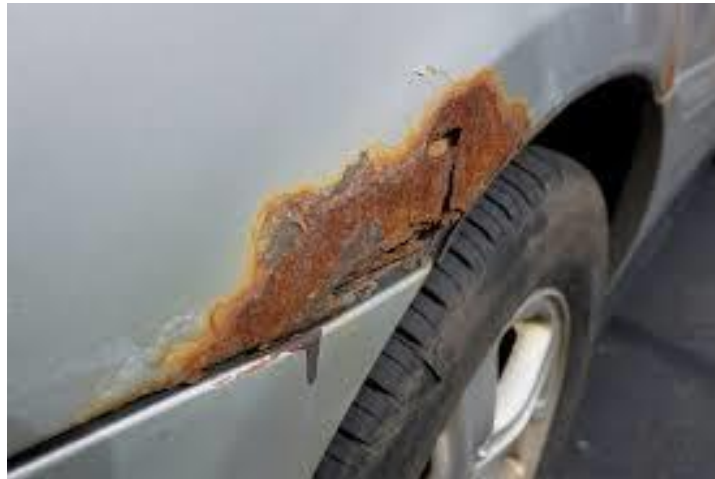
Slika 2. Korozija na automobilu [27]
