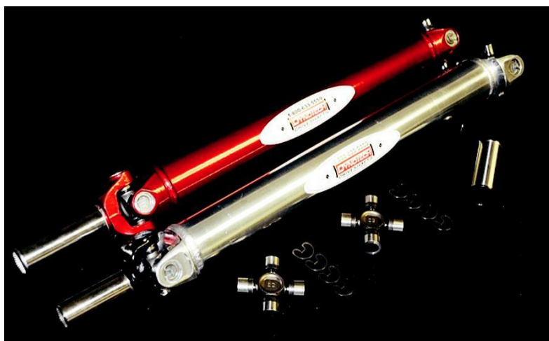
Slika 31. Kardansko vratilo Chevrolet Corvette [15]
