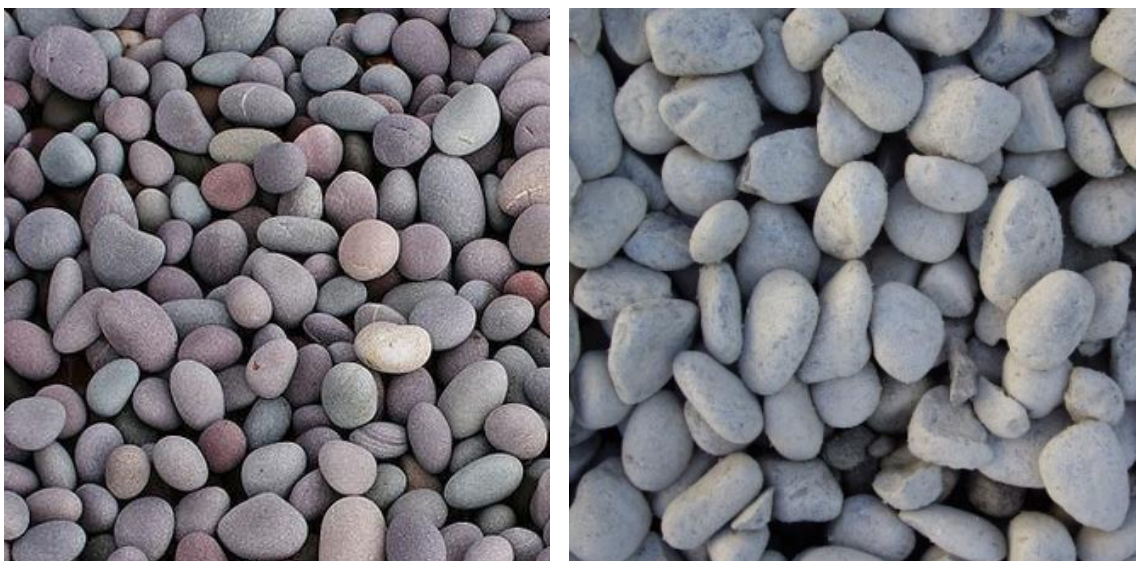
Slika 4.17. Šljunak – batuda, 16-32 mm
