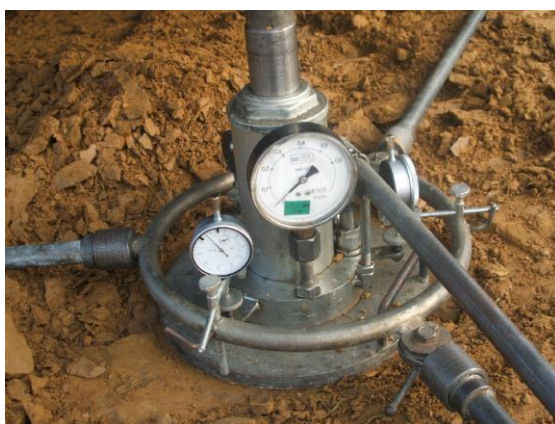
Slika 4.9. Statička kružna ploča
