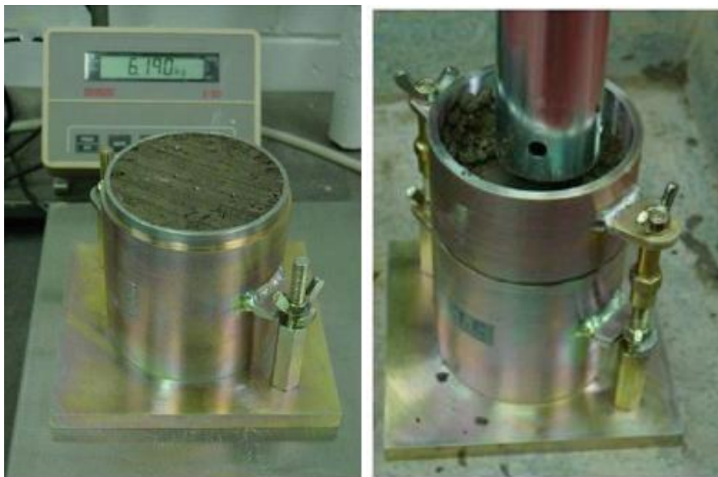
Slika 4.6. Zbijanje Proctorovim aparatom
