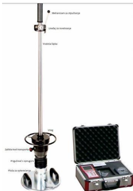
Slika 4.12. Dinamička kružna ploča
