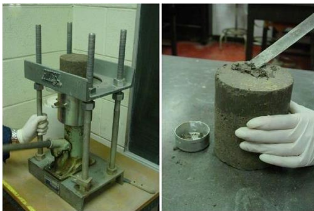
Slika 4.7. Završna obrada uzorka
