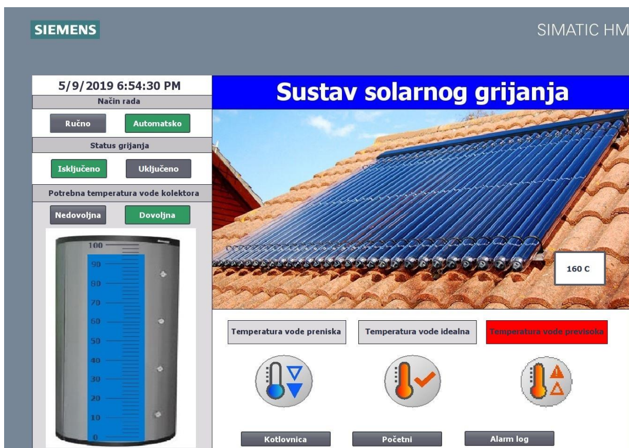
Slika 5.10 Isključivanje sustava radi prevelike temperature
