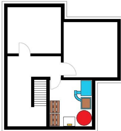
*Slika 5.2 Tlocrt podruma sa postrojenjem za grijanje vode*
