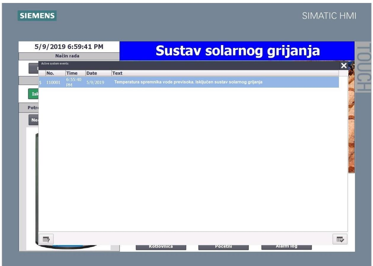
Slika 5.11 Prikaz pojave alarma na sustavu solarnog grijanja
