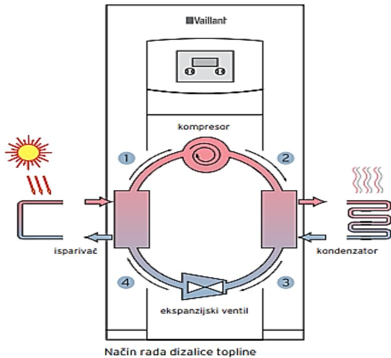
Slika 3.12 Prikaz kružnog procesa grijanja dizalice topline [18]
