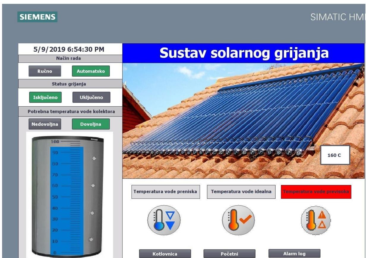
Slika 5.10 Isključivanje sustava radi prevelike temperature
