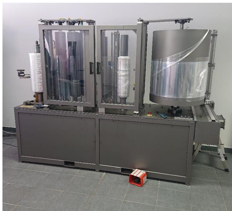
*Slika 28. uređaj za testiranje stretch folija*
