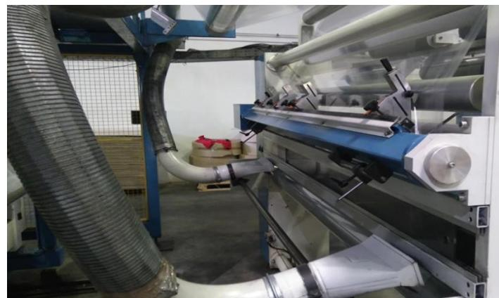
*Slika 14. zatezanie, rezanje i namatanje stretch folije*
