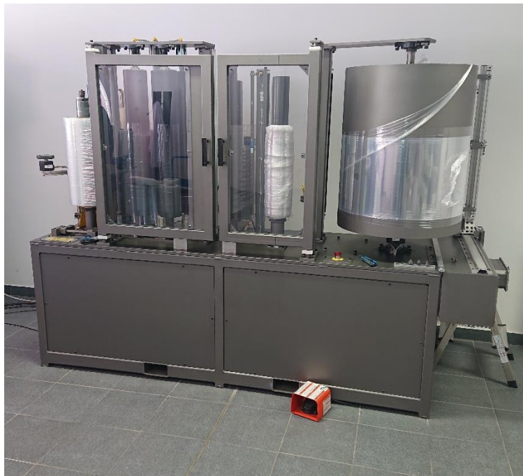
Slika 28. uređaj za testiranje stretch folija
