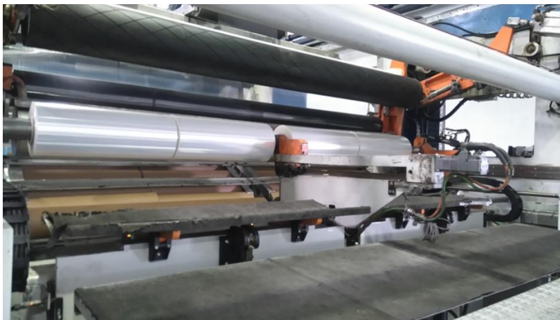
Slika 16. namatanje stretch folije na tuljke
