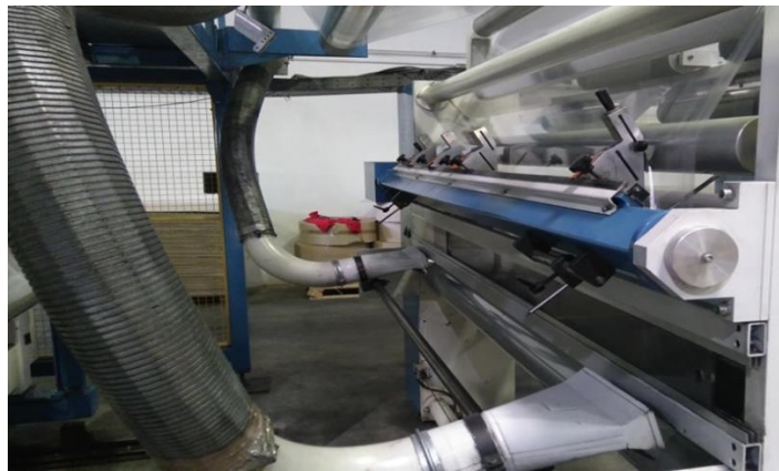
Slika 14. zatezanje, rezanje i namatanje stretch folije
