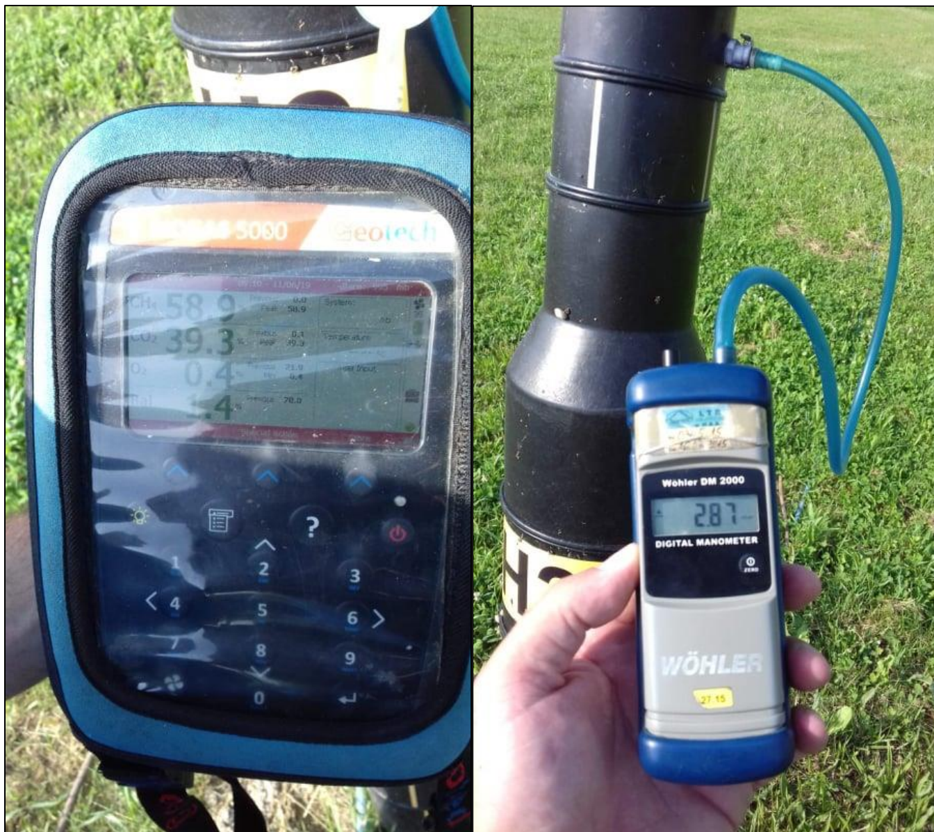
Slika 6.2. i 6.3. Mjerenje plina na sondama uređajima, postotak prisutnosti plina (CH 4 , lijevo), pritisak tlaka (desno)
