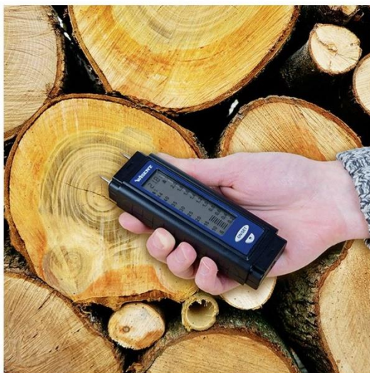
Slika 1.2. Prikaz mjerenja vlažnosti drva
