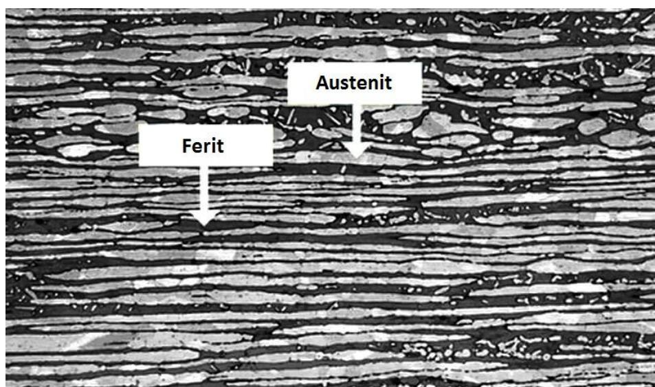
Slika 2.8 Mikrostruktura dupleks korozijiski postojanih čelika [25]
