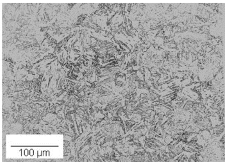
Slika 2.6 Mikrostruktura martenzitnog koroziju postojanog čelika [23]
