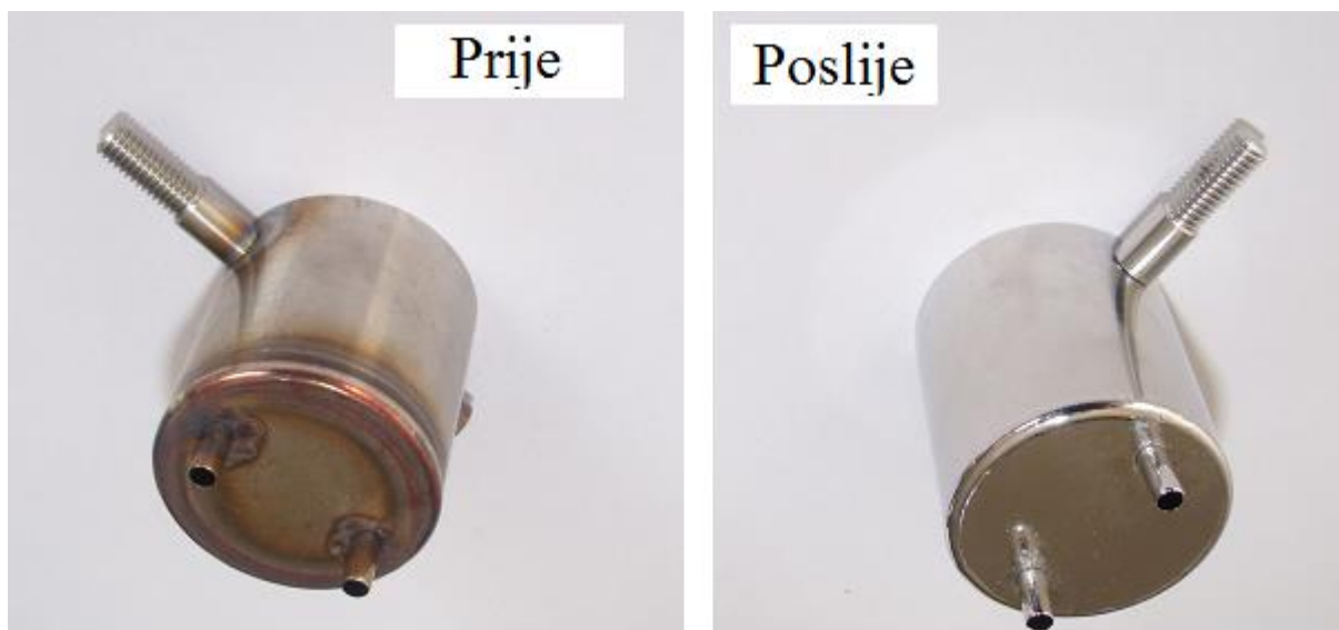
Slika 3.7 Proizvod prije i poslije procesa pasivacije [42]
