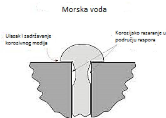
*Slika 1.9 Korozija u rasporu [13]*
