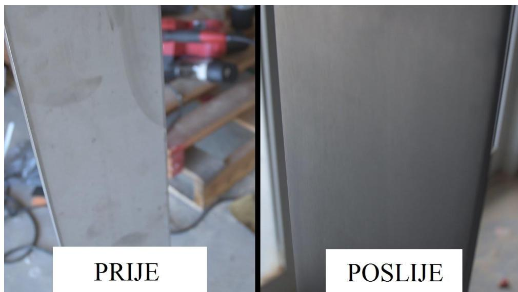
*Slika 3.2 Korozijijski postojani čelik prije i poslije brušenja [36]*
