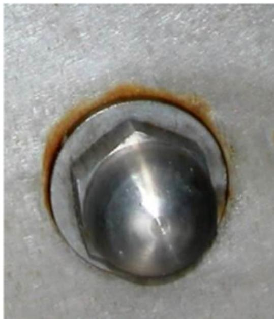
Slika 2.15 Korozija u rasporu između podloške i materijala [32]
