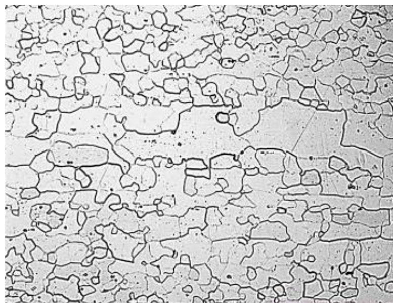
Slika 2.2 Mikrostruktura feritnih korozijski postojanih čelika [19]
