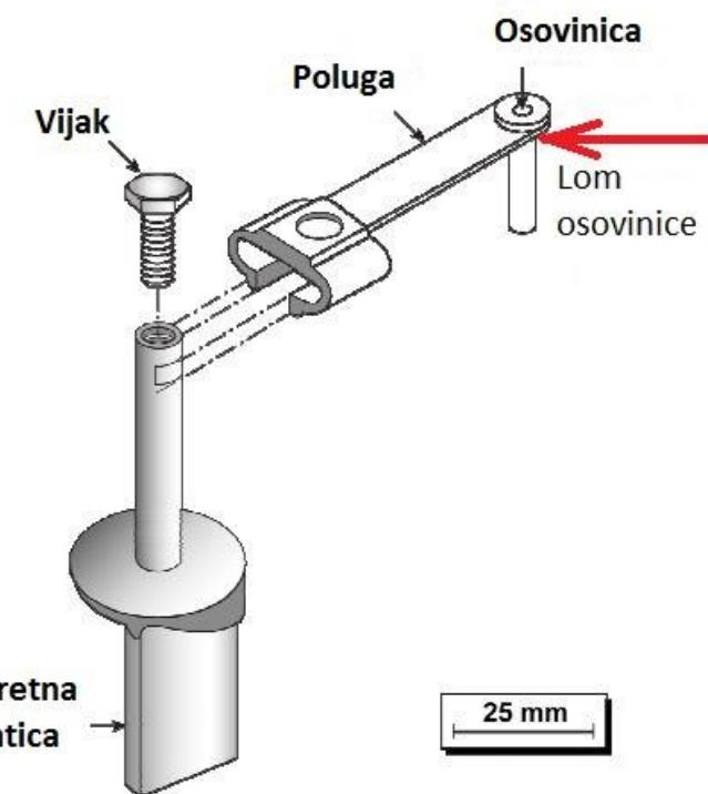
Slika 2.14 Lom osovinice zbog djelovanja napetosne korozije [30]
