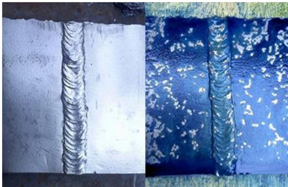
Slika 3.9 Obradak prije (lijevo) i poslije (desno) testa slobodnog željeza [44]
