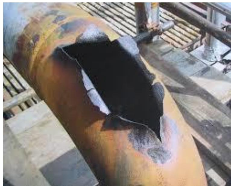
*Slika 1.11 Erozijsko korozionsko oštećenje cjevovoda za transport nafte [13]*
