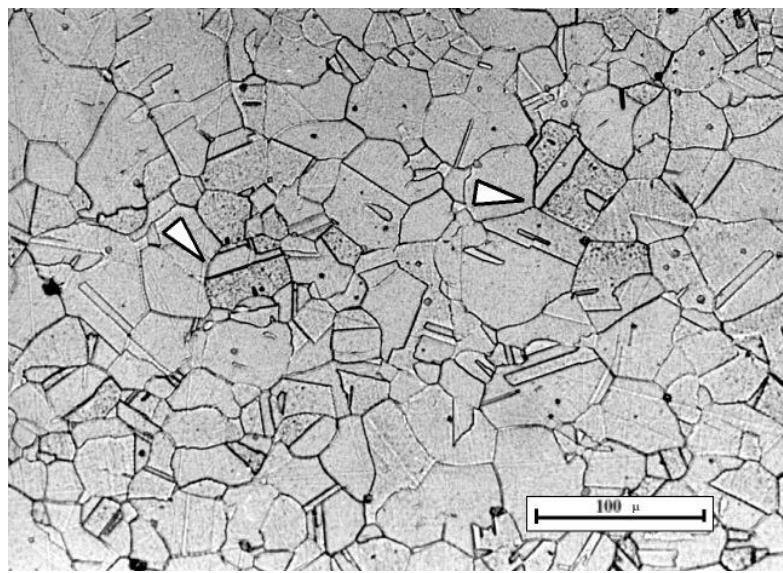
Slika 2.4 Struktura austenitnog korozijiski postojanog čelika [21]
