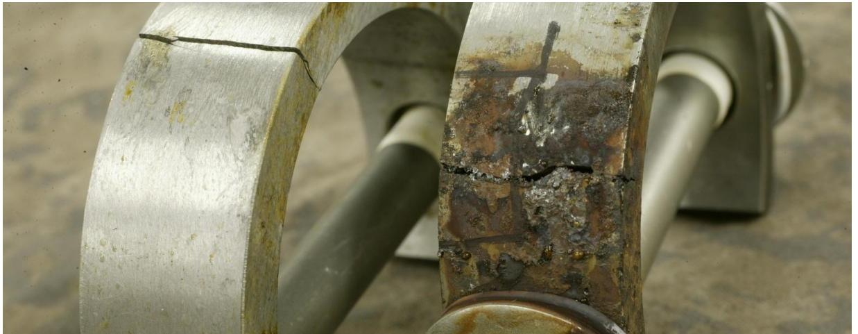
*Slika 2.12 Napetosna korozija [29]*
