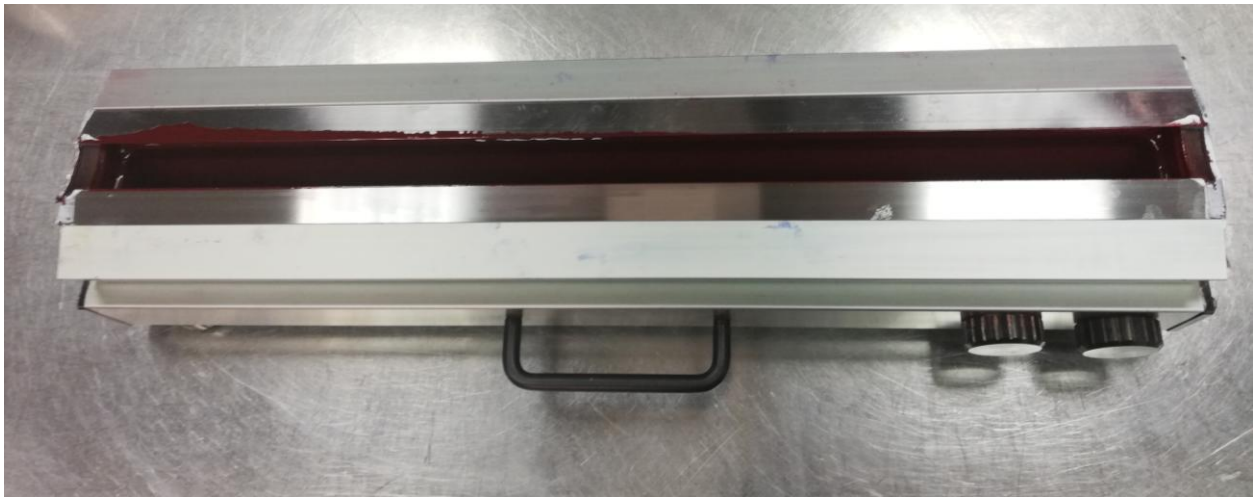
Slika 2.4 Komorni sistem bojanika
