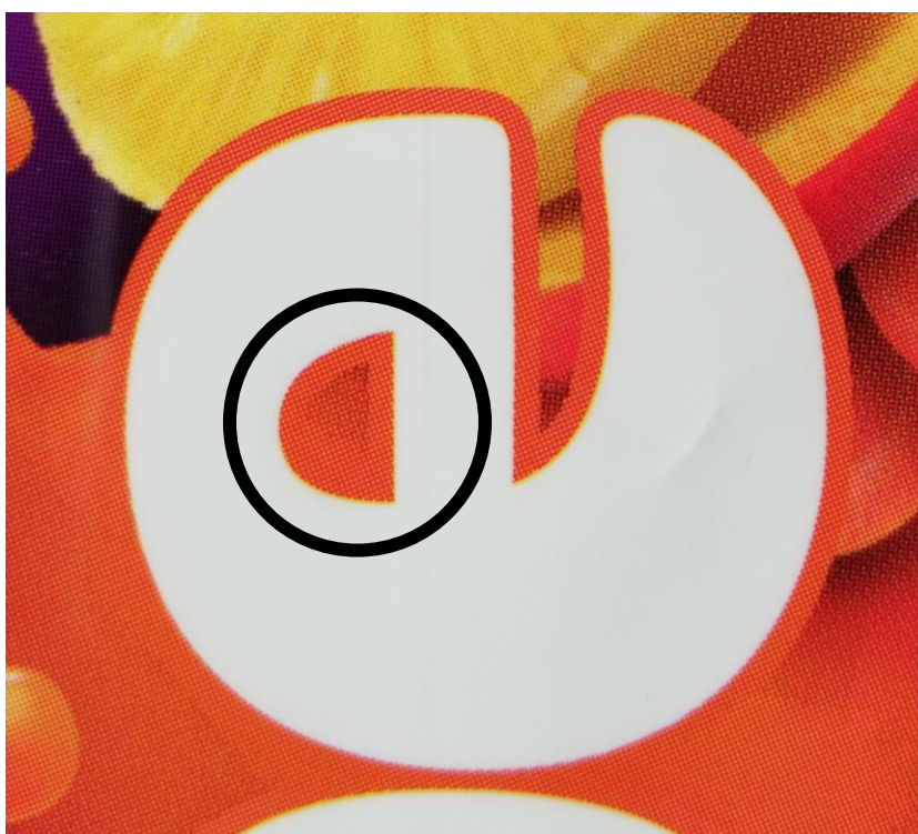
Slika 7.4 Uzorak br. 2 - izgled rastera nakon 100.000 otiska
