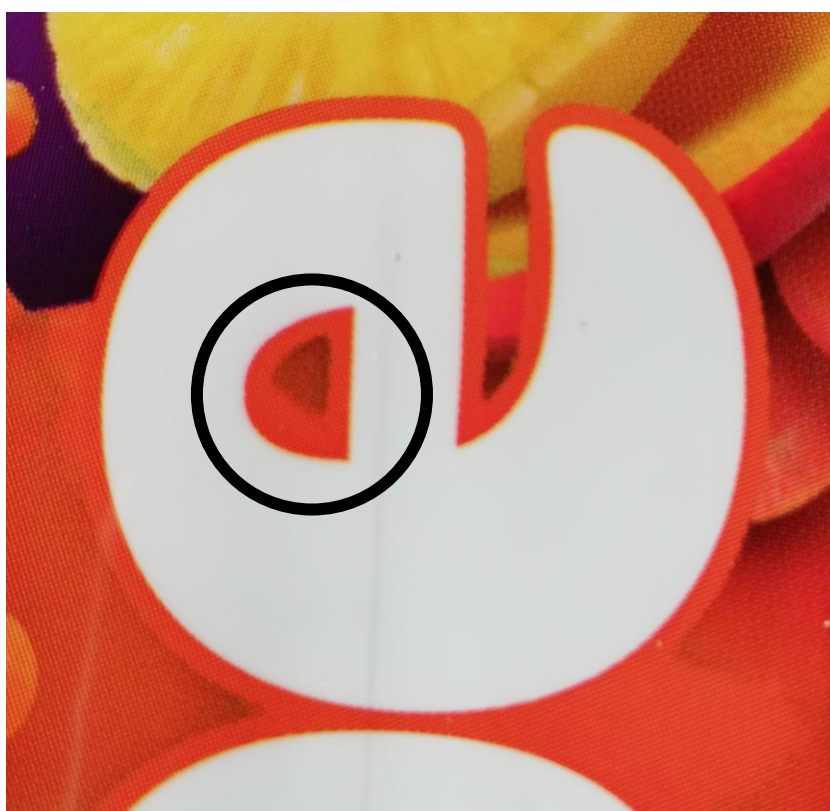
Slika 7.5 Uzorka br. 3 - izgled rastera nakon 500.000 otiska
