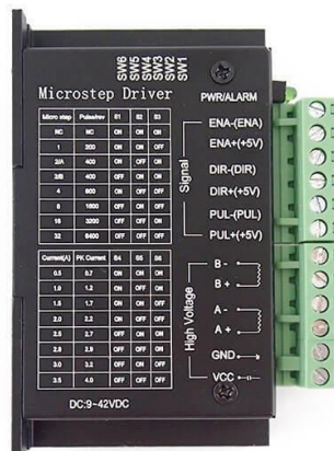
Slika 2.25. TB6600 upravljanje koračnih motora
