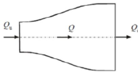
Slika 2.2 Redukcijska spojnica
