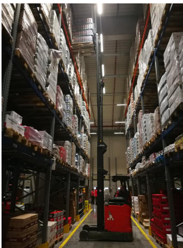
Slika 4.6 Odvoz palete sa prijemnih blokova te njihov smještaj na regale
