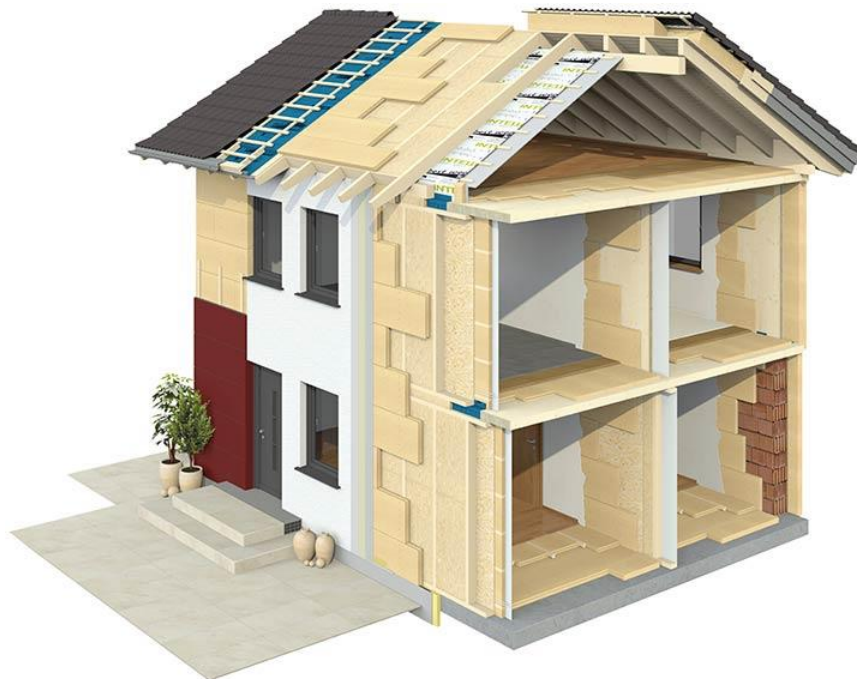
Slika 4.17 Izolacija obiteljske kuće od drvenih vlakana
