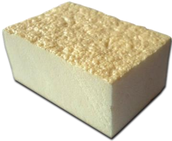
Slika 4.8 Poliuretanska pjena proizvedena u kalupu
