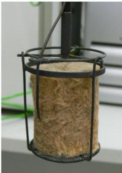
Slika 5.5 Uzorak kamene vune prije i poslije ispitivanja (promjena mase od 3,7%)
