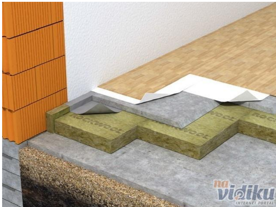
Slika 4.4 Postava kamene vune
