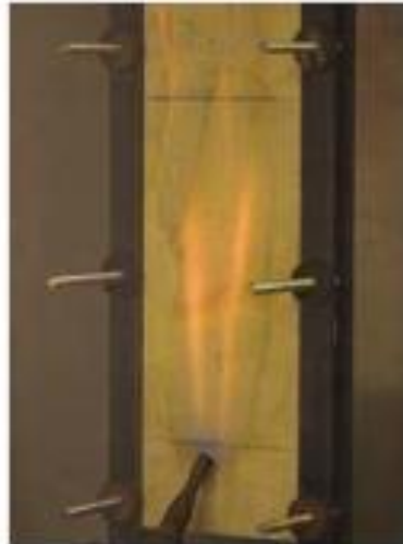
Slika 5.2 Aparatura za provođenje ispitivanja SFI metodom
