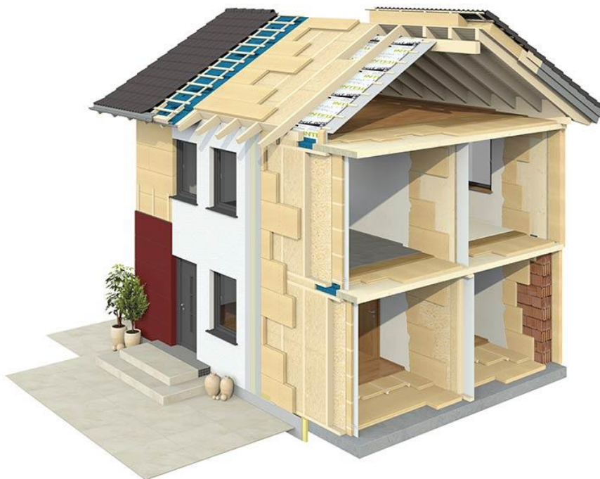
Slika 4.17 Izolacija obiteljske kuće od drvenih vlakana
