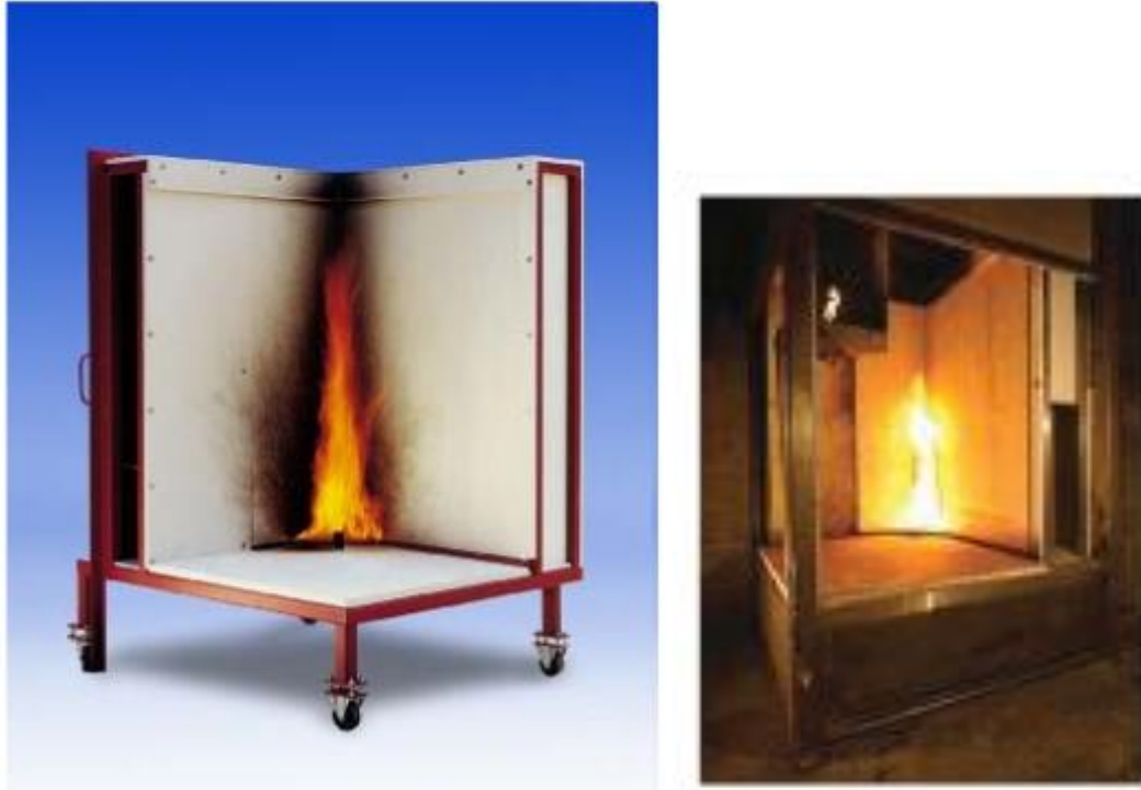
Slika 5.1 Aparatura za provođenje ispitivanja prema SBI metodi
