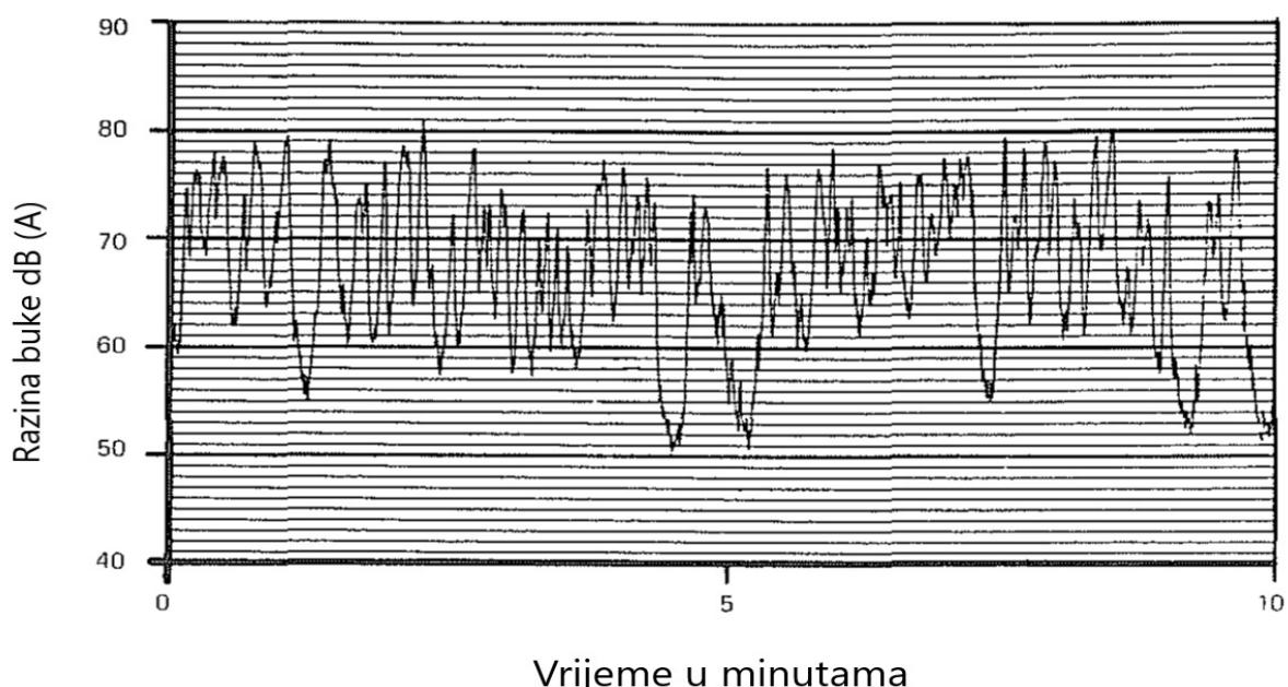
**Slika 1. Razina buke kod podloge od betonskog kolnika**
