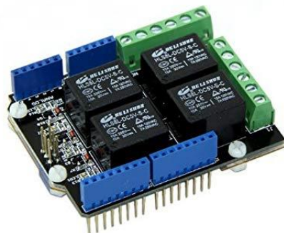
Slika 2.6 Prikaz relejnog štita za Arduino
