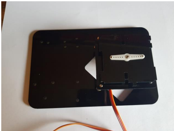
Slika 6.49 Sastavljanje podnožja makete s prvim motorom
