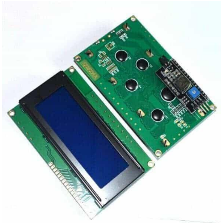
Slika 4: 2004A LCD Display sa I2C modulom
