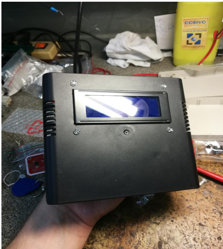
Slika 18: Kućište s montiranim LCD zaslonom
