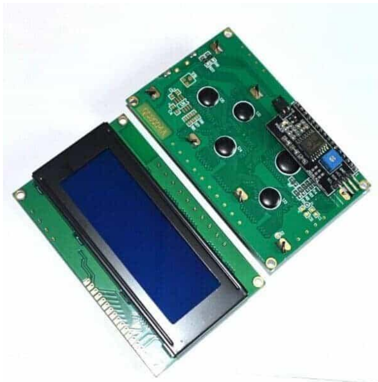
Slika 4: 2004A LCD Display sa I2C modulom
