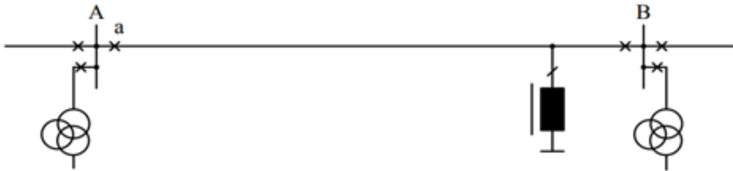
Slika 4.6 Kompensacijska prigušnica direktno priključena na vod[20]
