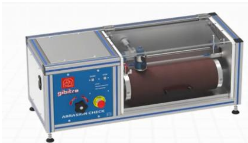
Slika 18. Gibitre Abrasiometre A- uređaj za ispitivanje trošenja
