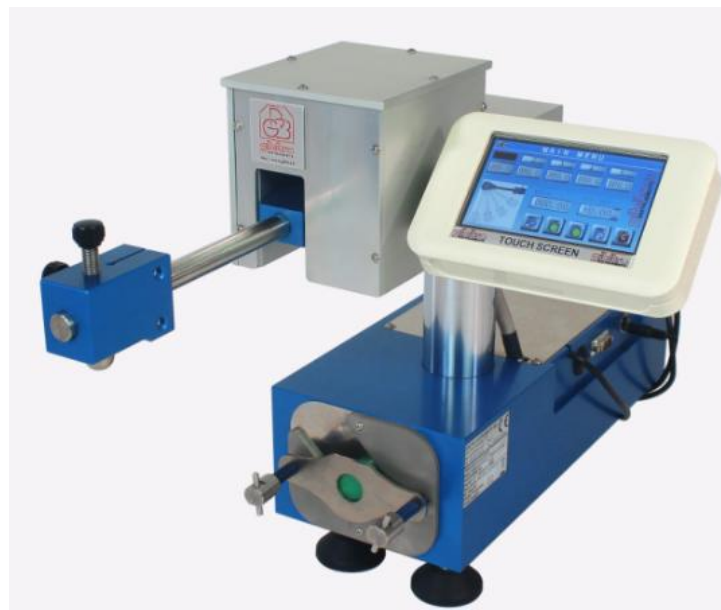
Slika 20. Gibitre Rebound Check – uređaj za ispitivanje odbojne elastičnosti
