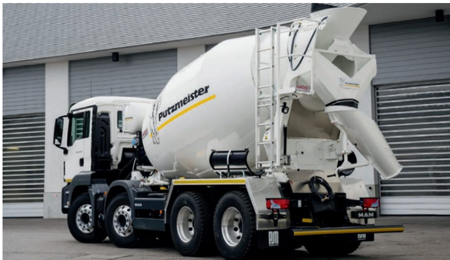
Slika 10. Cestovno vozilo za prijevoz građevnog materijala (mikser)
