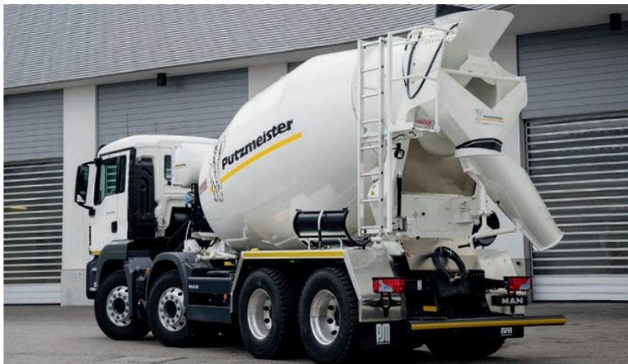
Slika 10. Cestovno vozilo za prijevoz građevnog materijala (mikser)
