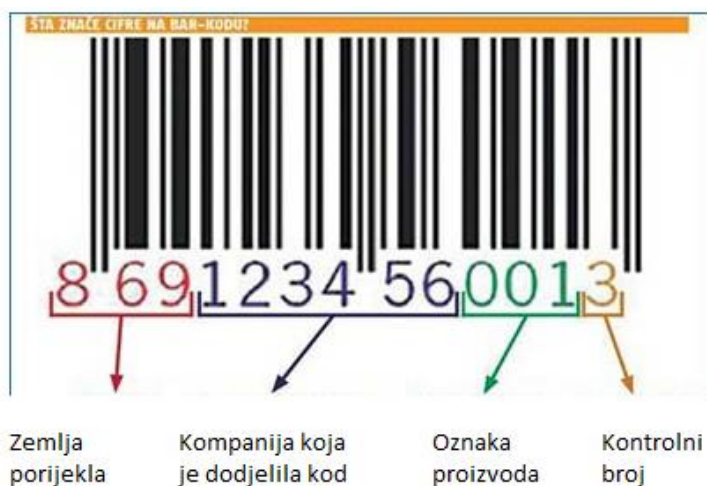
Slika 8 Značenje brojeva barkoda
