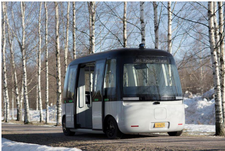
Slika 5.6. Gacha, prvi autonomni autobus koji može voziti u svim vremenskim uvjetima, izvor: [59]
