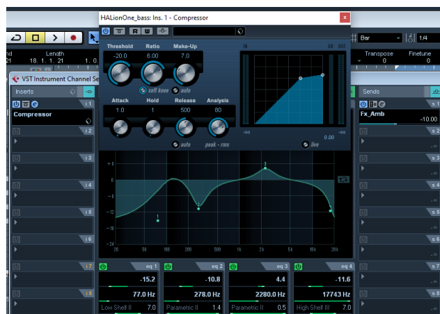
Slika 6.4.: Ekvalizacija i kompresija bas gitare
