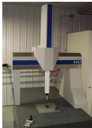
Slika 4.3. Konstrukcija koordinantnog mjernog uređaja [1]
