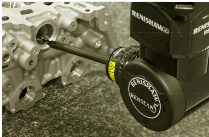
Slika 4.2. Senzor na vrhu mehaničke ruke [1]
