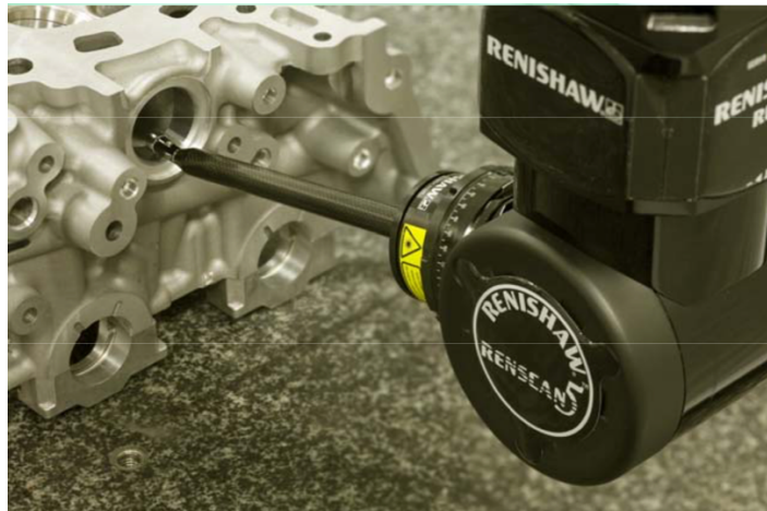
Slika 4.2. Senzor na vrhu mehaničke ruke [1]
