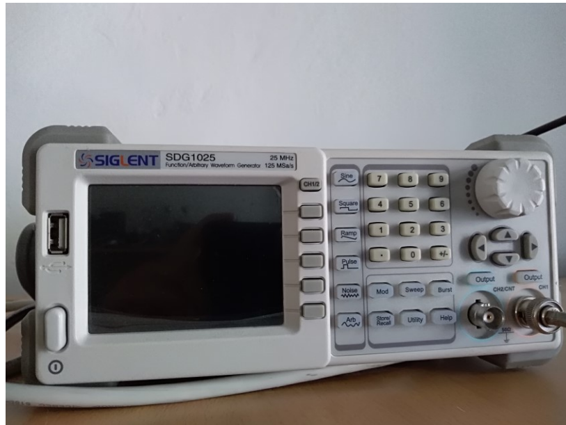
Slika 5.1 Funkcijski generator SIGLENT SDG 125
