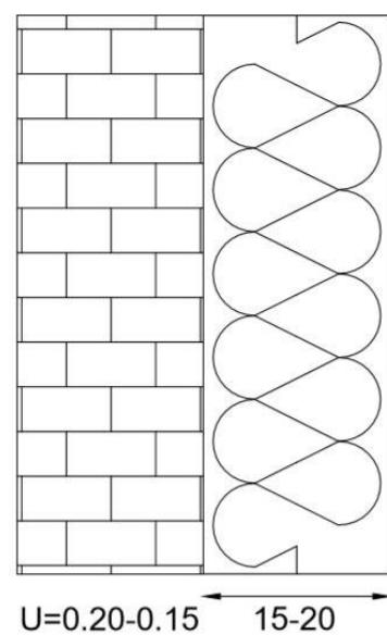
Slika 3.9. Usporedba debljina toplinske izolacije u odnosu na toplinske karakteristike vanjskog zida
