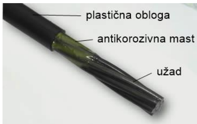
Slika 2.5. Unbonded kabel
