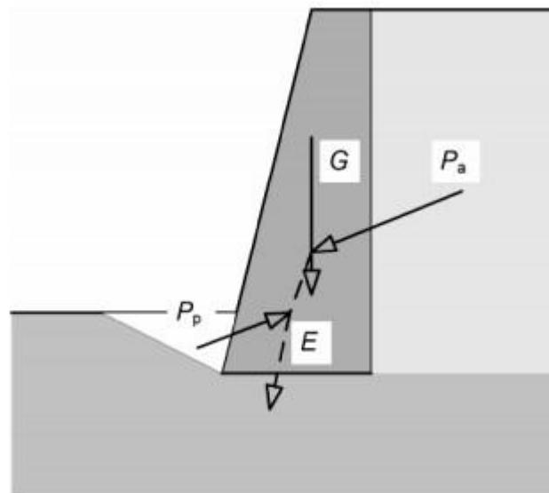
*SLIKA 8.: Pasivni otpor ispred zida*
