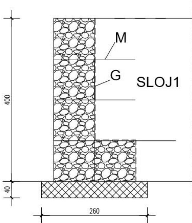
*Slika 19.:Gabionski zid*
