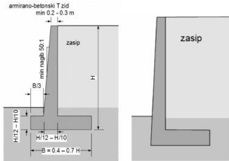
SLIKA 2: Armirano betonski gravitacijski T i L zidovi
