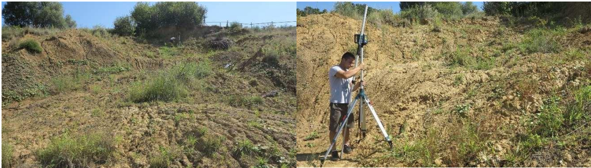
Slika 7.6. Mjerenje karakterističnih nagiba u zoni bušotine B11
