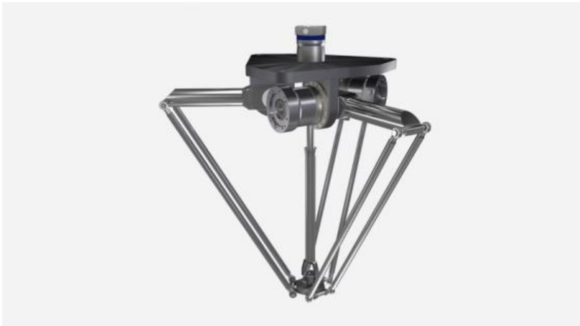
Slika 2-11 Paralelni robot (Delta robot) [22]
