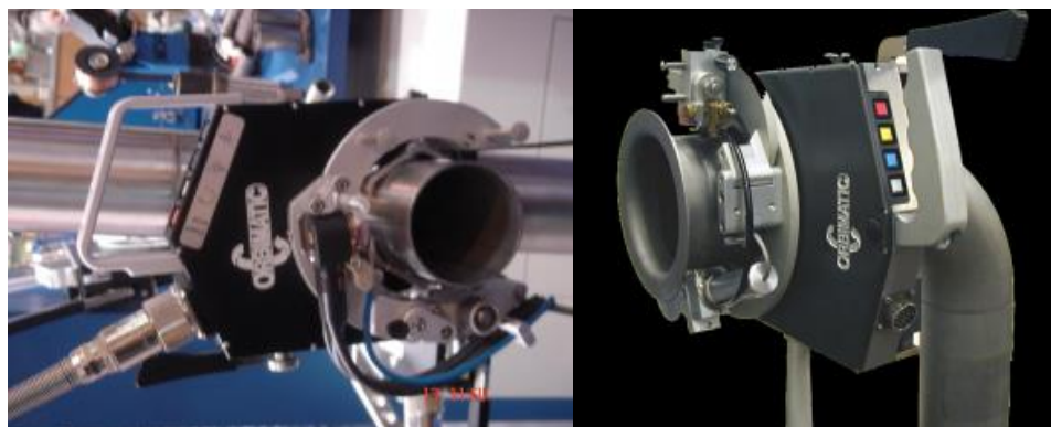
Slika 7.4.3. Otvorena glava sa AVC kontrolom (lijevo) i bez AVC kontrole (desno).[36]
