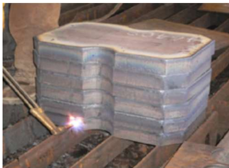
Slika 17 - Ručno zagrijavanje nakon rezanja [16]
