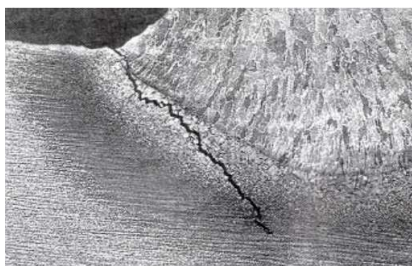
Slika 27 – Pukotina nastala u zoni utjecaja topline uz grubu strukturu zrna [18]
