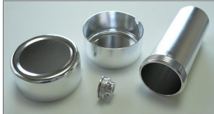
Slika 44.: Primjer kemijski poliranih predmeta [37]
