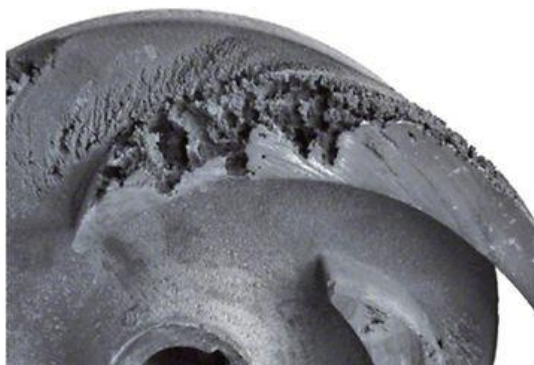
Slika 15.: Primjer kavitacijske korozije [16]
