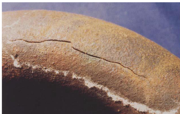
Slika 12.: Primjer napetosne korozije [12]
