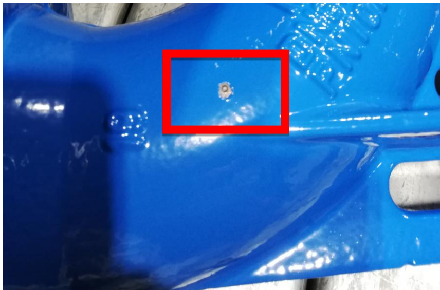
Slika 2.16 Oštećenje od prihvata [13]
