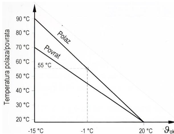
Slika 19. Dijagranski prikaz sustava grijanja s temperaturnim režimom 90/70 °C, te maksimalnom temperaturom polaznog voda 55 °C [6]
