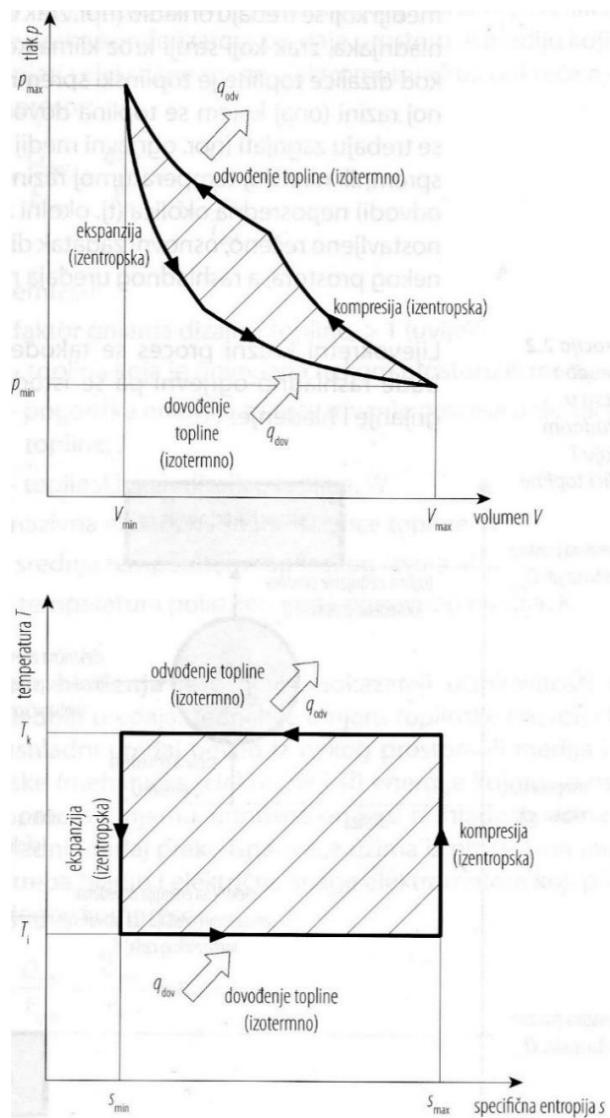
Slika 1. Prikaz teoretskog ljevkretnog Carnotovog kružnog procesa u p-V i T-s dijagramu [1]
