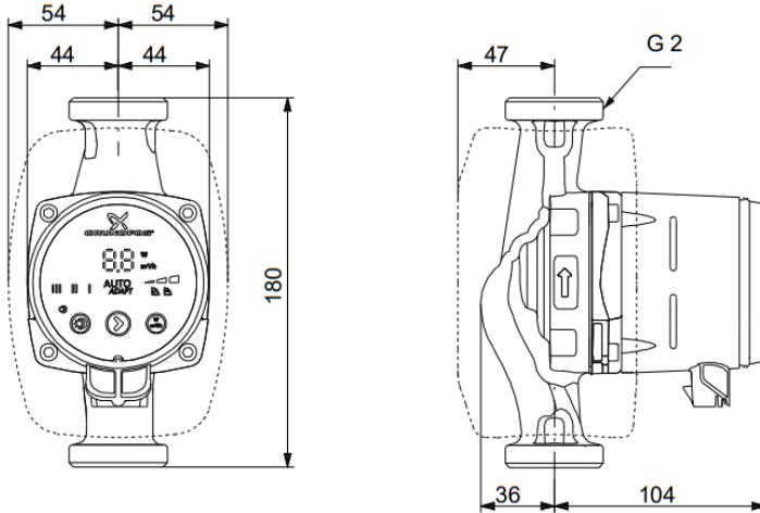
Slika 40. Tehnički podaci i dimenzije pumpe Grundfos ALPHA2 32-60 [13]
