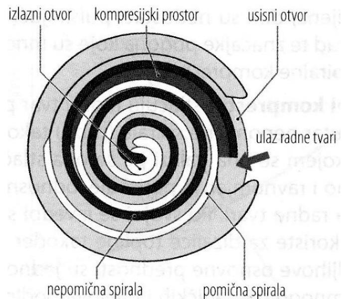
*Slika 7. Shema spiralnog kompresora [1]*
