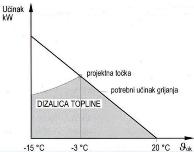
Slika 17. Dijagramske prikaz bivalentno - paralelnog načina rada dizalice topline i nekog drugog toplinskog izvora[6]
