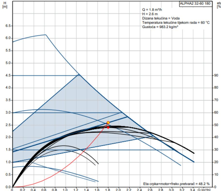
Slika 39. Karakteristika pumpe s ucrtanom radnom točkom[13]
