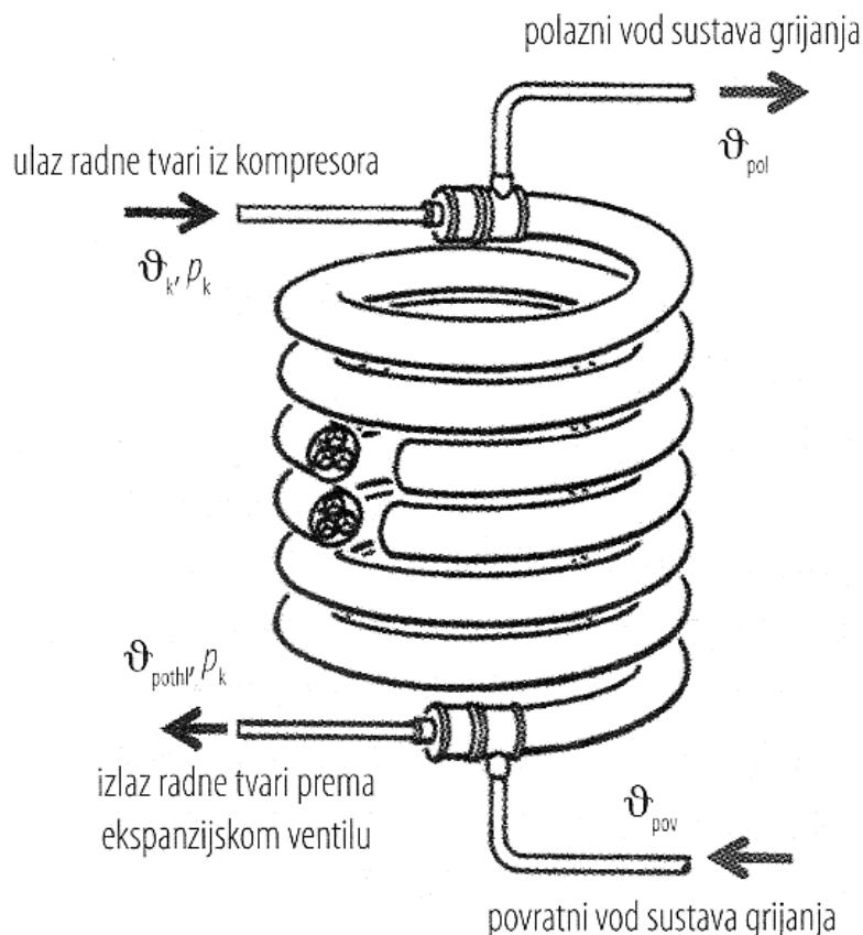
Slika 9. Prikaz kondenzatora s dvostrukom koaksijalnom cijevi [1]
