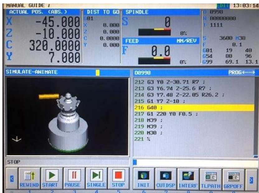
Slika 3.2.22 Grafička simulacija glodanja utora
