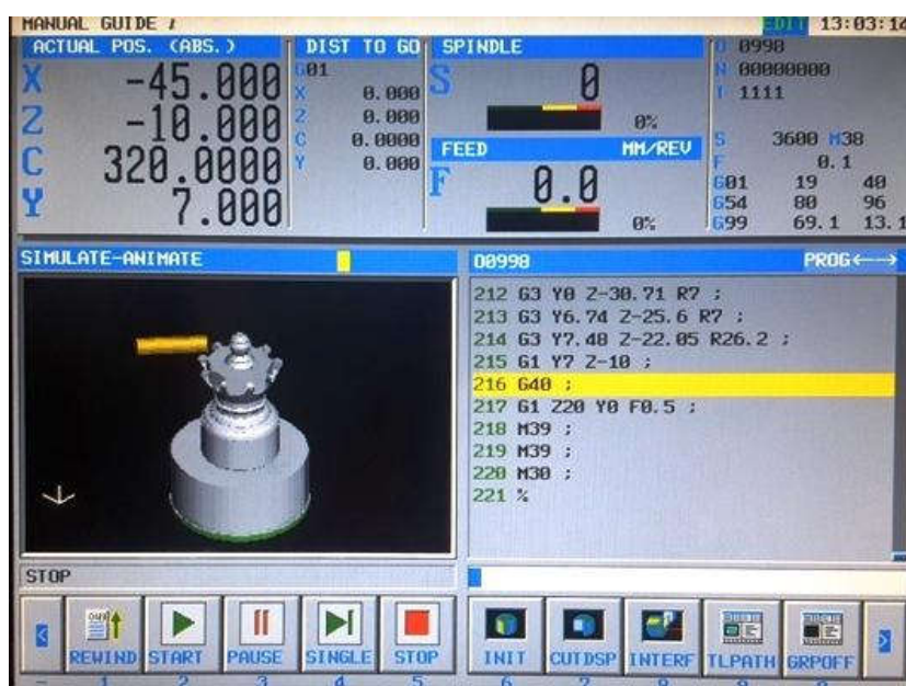
Slika 3.2.22 Grafička simulacija glodanja utora
