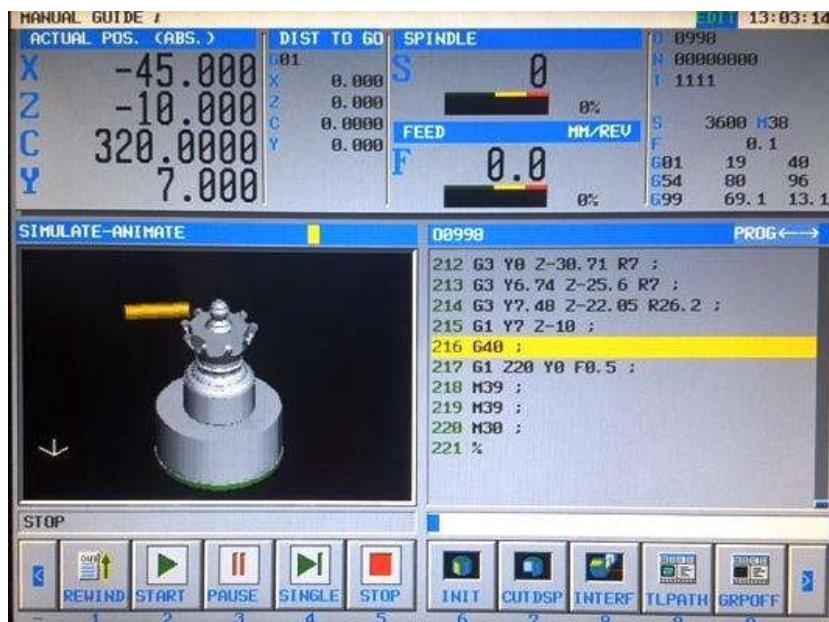
Slika 3.2.22 Grafička simulacija glodanja utora
