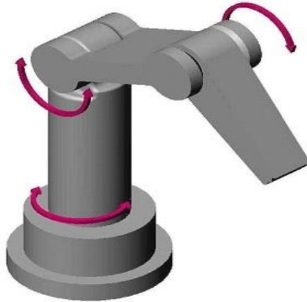
Slika 4. Rotacijska konfiguracija robota
