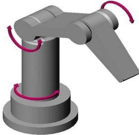
Slika 4. Rotacijska konfiguracija robota
